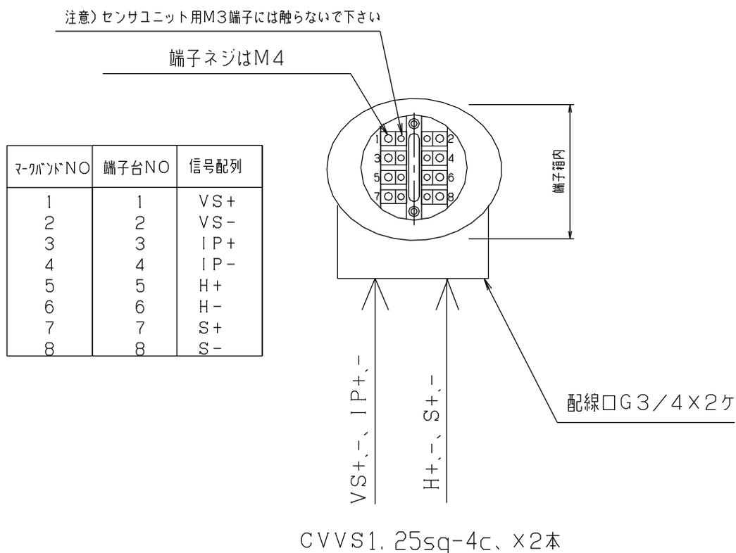
注意) ケーブルの外被は、配線口付近で端末処置し、リード線のみ端子箱内に入れる様にして下さい。
