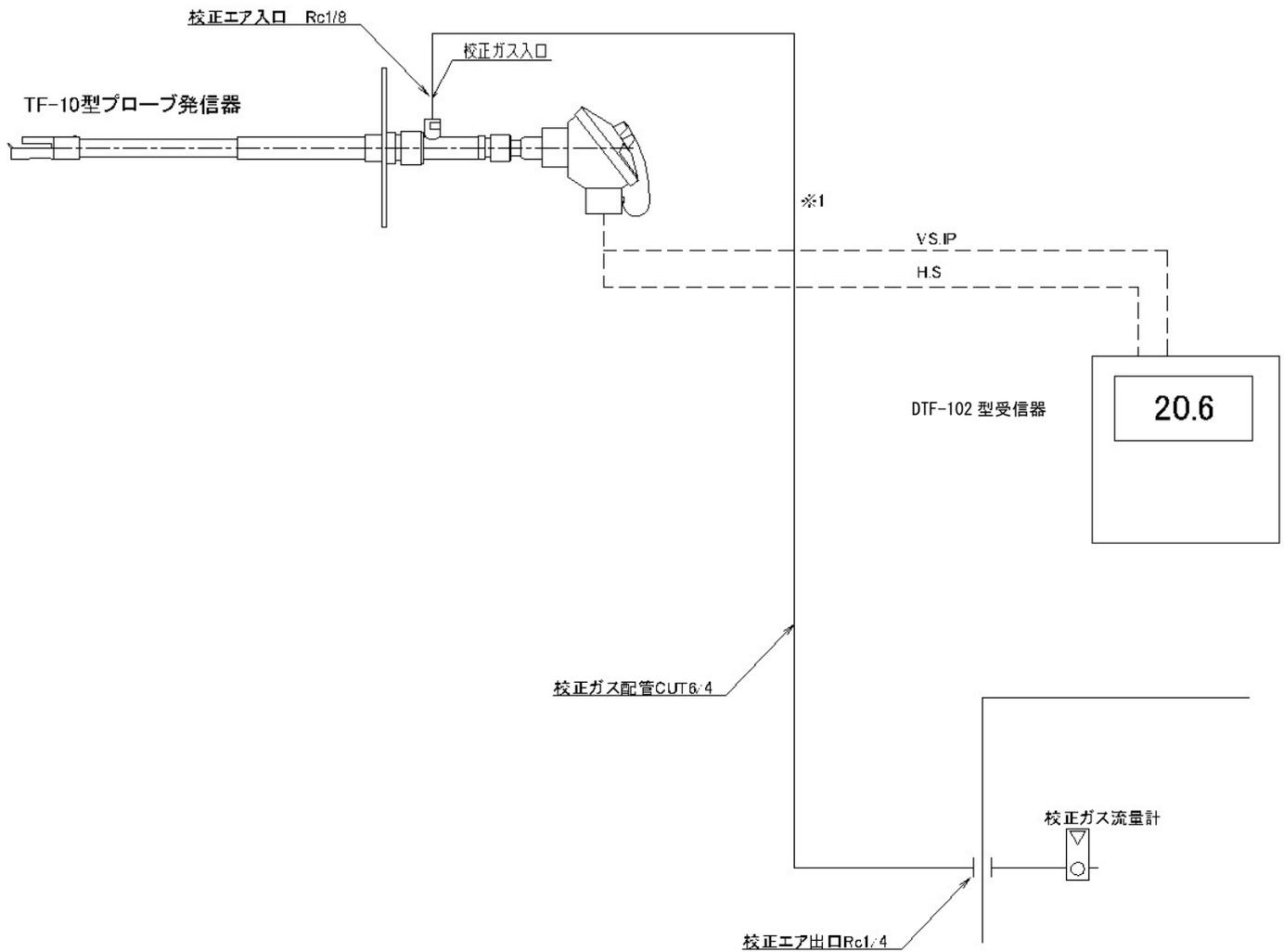
※1:この部分(プローブ長さ+1m)は、プローブ点検引抜き容易化用にフレキシブルコンジットとして下さい。
