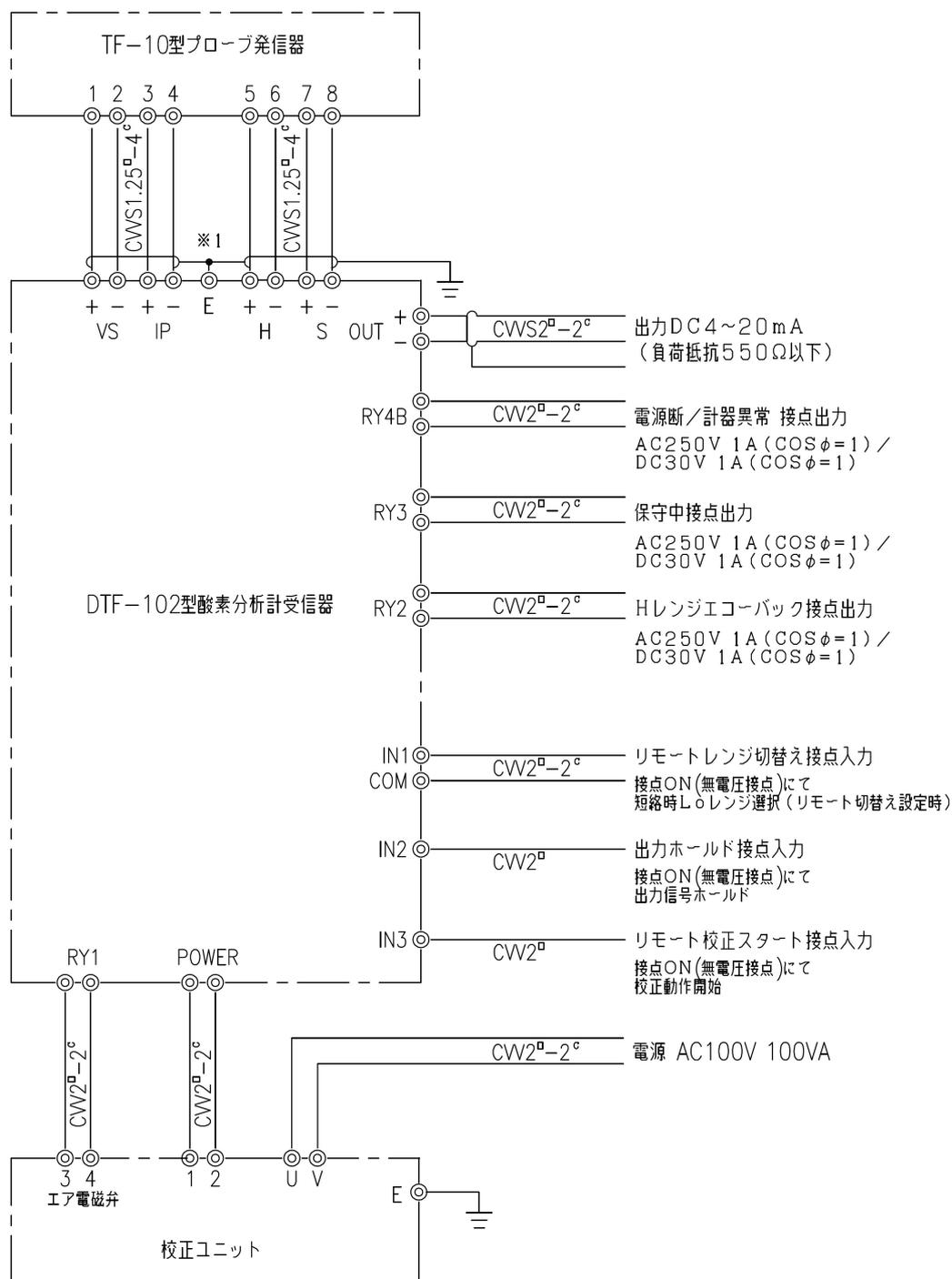
※1：3線接続となるため、受信器接地端子にアース板を取付け接続してください。
