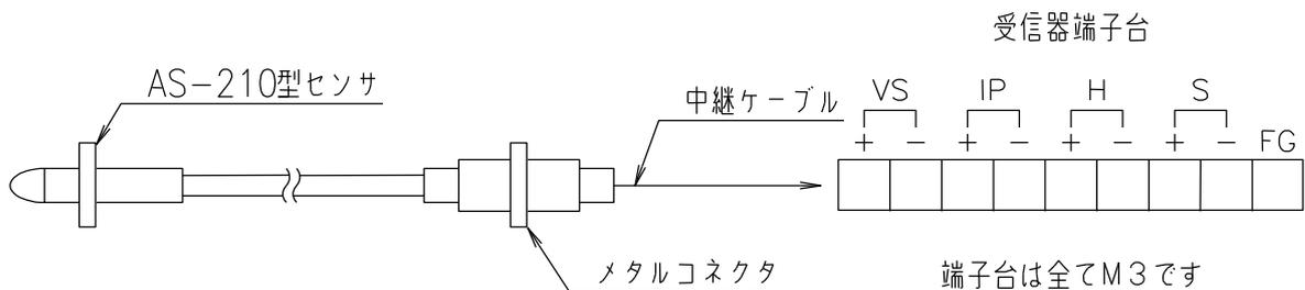
専用の中継ケーブルでセンサと受信器間を配線します。
